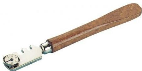
N'exige qu'une faible pression de coupe. Particulièrement adapté au verre technique tel que vitro-céramique. Tête en acier nickelé avec grugeoir - Manche bois. Inclus : 6 molettes de 4 mm en carbure de tungstène pour verre fin et/ou dur.
