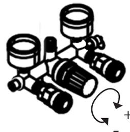
**NB :** Vérifier que la pression de réglage du détendeur soit toujours inférieure à la pression de redémarrage du contacteur manométrique. Sinon, vous n'aurez pas la pression désirée.
