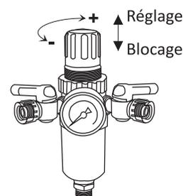
Débloquer le cabochon de l'épurateur-détendeur en le tirant vers le haut puis le tourner **Epurateur-détendeur** dans le sens des aiguilles d'une montre pour augmenter la pression, et dans l'autre sens pour la diminuer.
