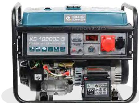
\*Les modèles de la série KS 10000E (monophasés) ont la possibilité de connexion de l'inverter de soudage avec le courant max. à 200A, à condition que l'inverter de soudage ait le rendement de 85 % et la tension d'arc de 25 V
