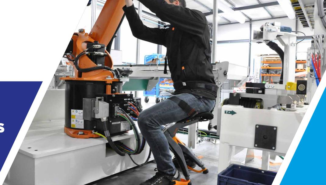
L'ergosquelette IP14 Chairless Chair® est un support ergonomique portable, léger flexible pour les positions d'assises, penchées ou demandant une alternance assis-debout.
