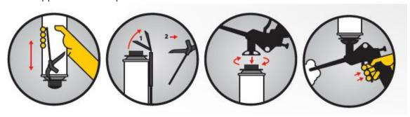
Pour le montage de mur, appliquer Rubson Fix Express en cordons d'environ 1 cm de diamètre avec un espacement de 3 cm afin de permettre, après écrasement, un encollage complet de l'élément. Encoller également la partie verticale.
