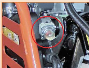
Carburateur avec système d'amorçage
