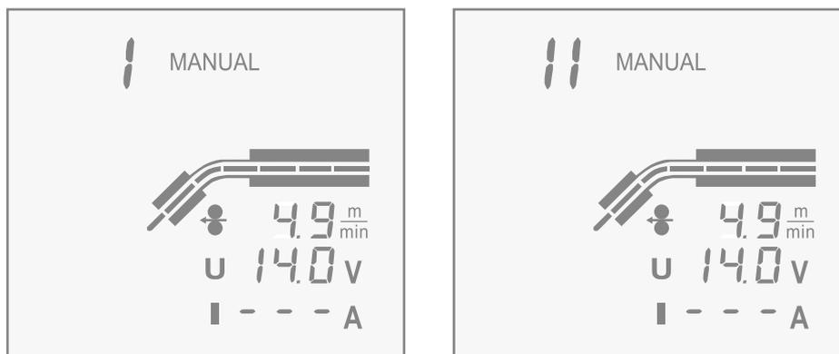
En mode manuel, vous pouvez choisir entre deux paramètres différents de dynamiques d'arc. Appuyez une fois sur le bouton (Réglage de la dynamique de l'arc sur le modèle MinarcMig 170) du mode manuel pour présélectionner la valeur dynamique de l'arc I ou II. Le fait de passer du paramètre I au paramètre II va ajuster les caractéristiques du court-circuit de façon à convenir à différentes applications de soudage.
