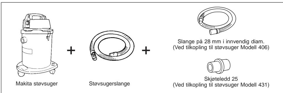
Ved tilkopling til Makita støvsamler (Modell 420), er den ekstra slangen eller skjøteleddet ikke nødvendig. Båndsliperen kan koples direkte til slangen på støvsamleren.
