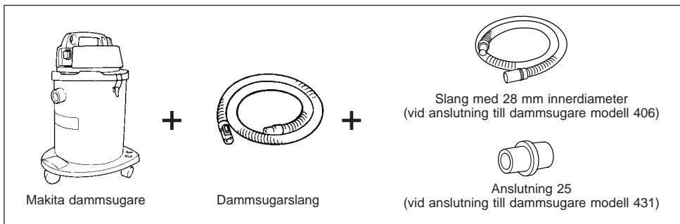
Vid anslutning till en Makita dammuppsamlare (modell 420) behövs inte den separata slangen eller anslutningen. Du kan ansluta bandslipmaskinen direkt till dammuppsamlarens slang.
