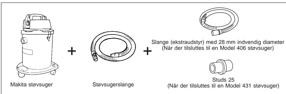
Når der tilsluttes til en Makita støvopsamler (Model 420), er ekstraudstyrsslangen og studsen ikke nødvendige. De kan tilslutte båndsliberen direkte til slangen på støvopsamlene.
