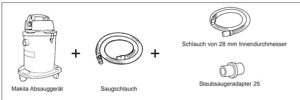
Zum Anschluß an ein Makita-Absauggerät wird ein gesonderter Schlauch von 28 mm Innendurchmesser oder ein Staubsaugeradapter 25 benötigt. Siehe Abbildung unten.
