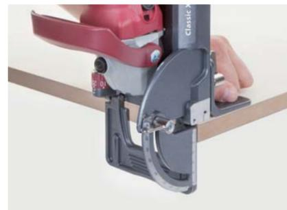
**Stabilité verticale** assurée par la butée mise sur la plaque de base comme agrandissement de la surface d'appui
