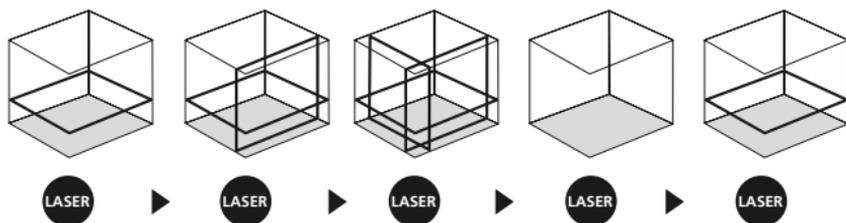
**!** Voor de horizontale en verticale nivellering moet de transportbeveiliging gedeactiveerd zijn. Zodra het apparaat zich buiten het automatische nivelleerbereik van  $3^\circ$  bevindt, knipperen de laserlijnen en brandt de led rood. Positioneer het apparaat zodanig dat het zich binnen het nivelleer-bereik bevindt. De led schakelt weer over naar groen en de laserlijnen branden constant.
