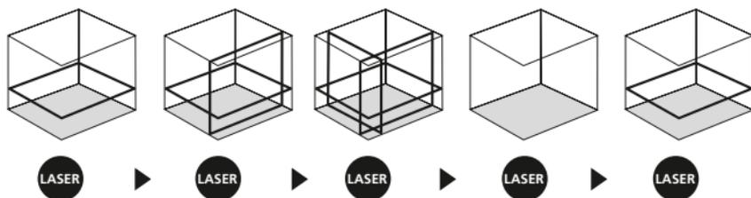
**!** Zum horizontalen und vertikalen Nivellieren muss die Transportsicherung gelöst sein. Sobald sich das Gerät außerhalb des automatischen Nivellierbereichs von  $3^\circ$  befindet, blinken die Laserlinien und die LED leuchtet rot auf. Positionieren Sie das Gerät so, dass es sich innerhalb des Nivellierbereichs befindet. Die LED wechselt wieder auf grün und die Laserlinien leuchten konstant.
