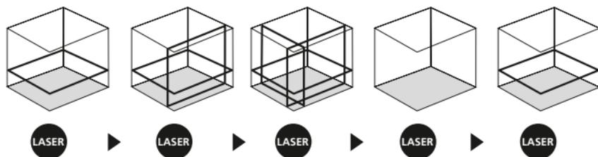
**!** Per il livellamento orizzontale e verticale si deve allentare la sicura di trasporto. Non appena l'apparecchio si venisse a trovare al di fuori del campo di livellamento automatico di 3°, le linee laser iniziano a lampeggiare e si accende la luce rossa del LED. Posizionare l'apparecchio in modo che si trovi all'interno del campo di livellamento. La luce del LED diventa verde e le linee laser emettono una luce costante.
