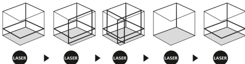
! Til horisontal og vertikal nivellering skal transportsikringen være løsnet. Så snart apparatet er uden for det automatiske nivelleringsområde på 3°, blinker laserlinjerne, og lysdioden (LED) løser rødt. Apparatet skal positioneres således, at det er inden for nivelleringsområdet. Lysdioden skifter igen til grønt, og laserlinjerne lyser konstant.
